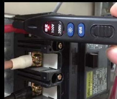
非接触(被覆)検電(LEDとブザーでお知らせ) ※点灯時は赤色点灯
