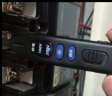
100V/200V判別(LEDとブザーでお知らせ) ※写真は200V点灯時(青色点灯)。100V点灯時は緑色点灯
